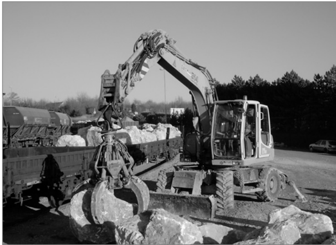
Figure 9.37 Chargement d'un train au grappin au terminal ferroviaire de la carrière (source: Carrières du Boulonnais)
