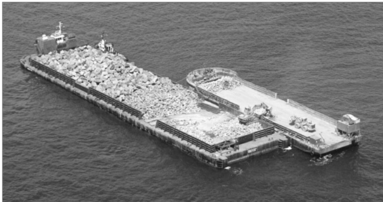
Figure 9.38 Barge à pont plat de 20 000 t pour enrochements (source : Stema Shipping Ltd)
