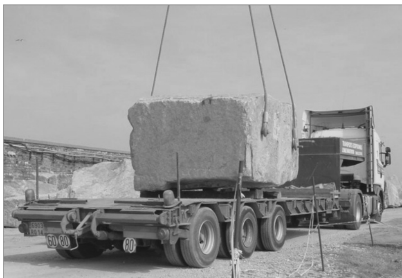
Figure 9.31 Camion à plateau utilisé pour transporter des gros blocs d'enrochement pour la réparation de la digue de Cherbourg (source : Service des Infrastructures de la Défense)
