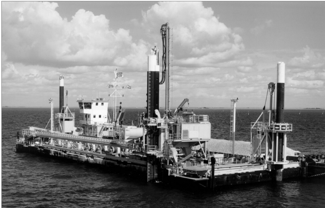
Figure 9.25 Ponton auto-élévateur polyvalent avec tube plongeur fermé muni d'une règle à araser (source : Royal Boskalis Westminster)
