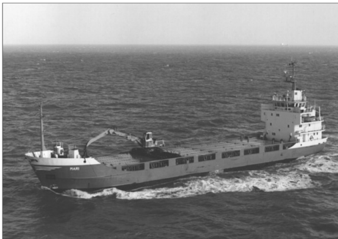
Figure 9.39 Navire MV Mari à chargement et déchargement autonome (source : Sillanpää)
