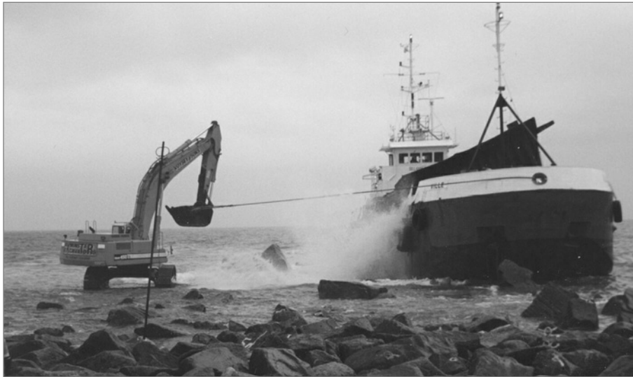
Figure 9.41 Navire à déchargement latéral par basculement MV Ville (source: Sillanpää)
